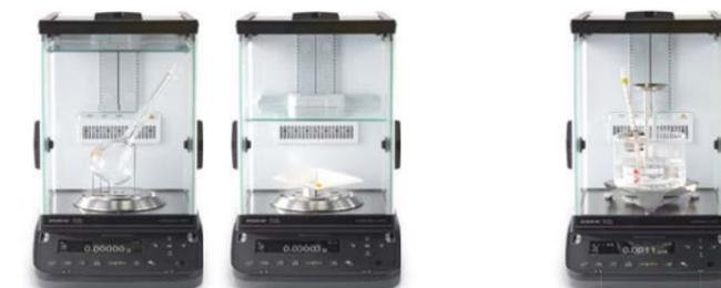
可以5 mm 为单位调整高度。根据使用的容器及样品调整高度，使称量室内达到最佳状态。
