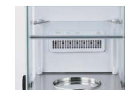
防风内板(选配件)可抑制称量室内的对流及气流的影响。
