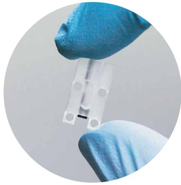
图 2 单细胞分离系统使用的一次性、无菌细胞分离槽。
