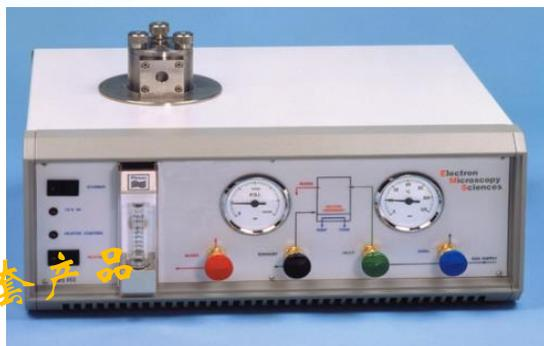
EMS 850通过使用CO<sub>2</sub>, 在试样中最先通过一系列脱水代替水份, 常在同样的液体如丙酮这样的中间液体中. (湿样品)水-丙酮-30%-100%-CO<sub>2</sub>-C.P.D.-(干样品)
