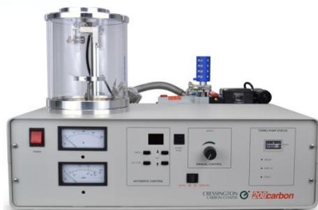
208C分子泵超高真空镀碳系统, 拥有多项独特技术, 配合原装超纯石墨靶材可获得最高质量的碳膜, 特别适合TEM(Cs), STEM 制样及制作无定形碳覆膜和TEM栅网支持膜等应用;
