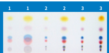
接触式点样展开后的薄层板
