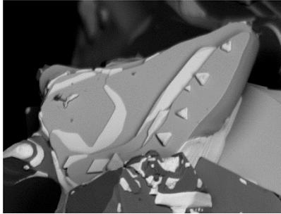
在5kV低电压下对BiCaCo陶瓷材料进行背散射电子成像，从而研究这类钴酸盐材料的热电性质
