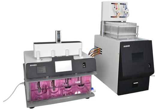
QY8 取样器是天发分析自主研发的新型取样器，可适配具有取样系统的溶出仪，可连接组成溶出取样系统。可升级 WiFi、RS232、RS485、LAN、蓝牙数据接口。全系采用 26ml 高精密注射器作为取样动力。取样速度快、精度高。全系具有初滤液和分配功能、可实现初滤液废弃、续滤液分配留样。并且可以将样品直接收集至安瓿瓶。采用 8 路精密注射泵实现高精度自动过滤、取样和补液，拥有多项专利技术，结构先进，控制准确，智能化程度高。
