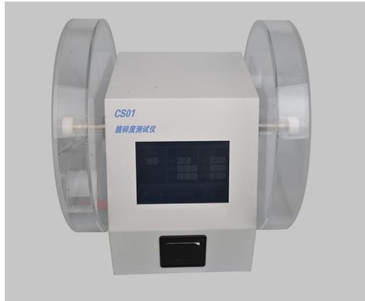
JH-CS01 脆碎度测试仪功能齐全，操作简便，可以实现固定圈数测量或连续测量。采用 DSP 高细分驱动器使转速更稳定、精确，转速可调。配备热敏打印机在线打印。配备大尺寸彩色触摸屏，数据显示更直观、清晰。其性能指标符合《中国药典》及美国药典的相关规定。能够满足各大药厂、药检所及药研单位需求。
