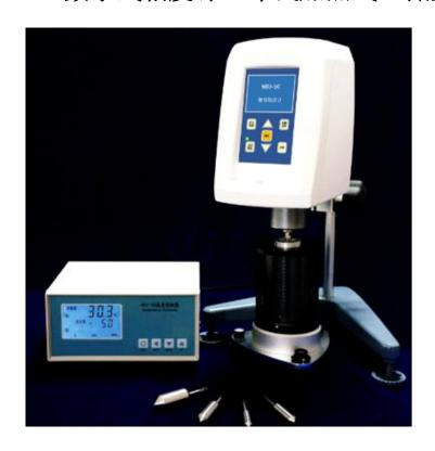
全新设计的 NDJ-1C 高温布氏旋转粘度计不仅在外形上更具有现代美学的元素,而且操作更方便,测值更准确,功能更齐全。布氏旋转粘度计(NDJ-1C)可测定热熔胶、沥青、石蜡等高温熔融材料的动力粘度。本机采用国际最新的微电脑驱动技术、进口步进电机、液晶背光显示,具有定时测量、水平泡前置,转速平稳、准确性好、程序化设计、操作简便、出错报警等功能,屏幕直接显示粘度、转速、百分计扭矩、转子编号、被测液体的温度等信息。该仪器满量程、各档线性度全部通过 PC 接口、用不同粘度的标准样品进行计量校正,确保仪器具有很好的精度和重复性。
