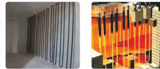
1700°C炉膛和硅钼棒发热体
