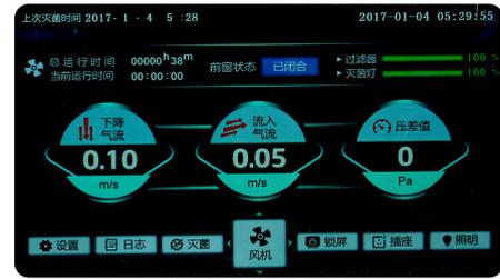
实时显示风机运行的时间进度,前窗的状态,过滤器、灭菌灯的寿命百分比,控制插座、照明、灭菌及风机的输出和关闭操作,查看操作日志并提供报警功能,无需切换界面
