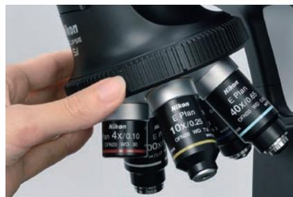
容易旋转的五孔物镜转换器
