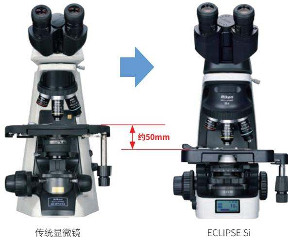
ECLIPSE Si载物台的高度为135 mm，比传统显微镜的低50 mm左右。低载物台的设计可减少交换标本载玻片所需的移动范围，继而可减少手臂和肩膀的疲劳。由于载物台摇杆的位置也较低，因此当您把手放在工作台上时，可轻松观察标本载玻片上的不同区域。用于打开和关闭标本夹的操纵杆也被设计为符合人体工程学的尺寸和形状，易于操作。此外，ECLIPSE Si的载物台要比传统显微镜的小30%，从而优化载玻片更换。
