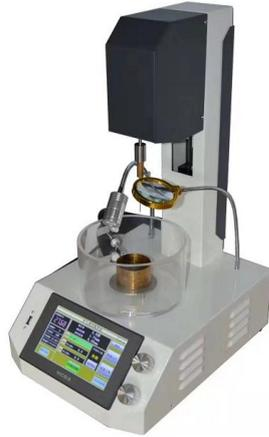
药物锥入度测定仪是根据中华人民共和国标准 2020 年药典《0983 锥入度测定法》和 GB1790-2003《医药凡士林》标准中规定的技术要求和有关规定设计制造的一款自动智能型仪器，主要适用于适用于软膏剂、眼膏剂及其常用基质材料（如凡士林、羊毛脂、蜂蜡）等半固体物质，以控制其软硬度和黏稠度等性质，避免影响药物的涂布延展性。药物锥入度系指利用自由落体运动，在 25℃ 下，将一定质量的锥体由锥入度仪向下释放，测定锥体释放后 5 秒内刺入供试品的深度。
