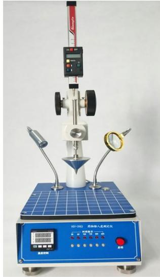
本仪器是根据中华人民共和国标准 2020 年药典《0983 锥入度测定法》技术要求和有关规定设计制造的，主要适用于适用于软膏剂、眼膏剂及其常用基质材料（如凡士林、羊毛脂、蜂蜡）等半固体物质，以控制其软硬度和黏稠度等性质，避免影响药物的涂布延展性。药物锥入度系指利用自由落体运动，在 25℃下，将一定质量的锥体由锥入度仪向下释放，测定锥体释放后 5 秒内刺入供试品的深度。
