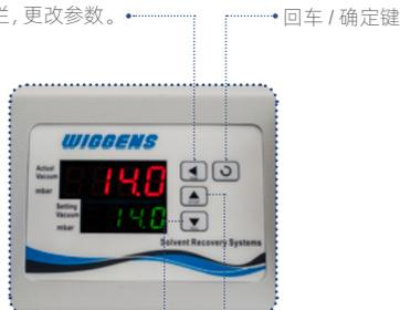
“run” 键为隔膜泵启动运转键；另外此键也可作为下调参数键。
