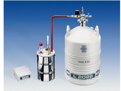
**应用案例 1: 用于张力试验的全自动液氮液位控制:**
