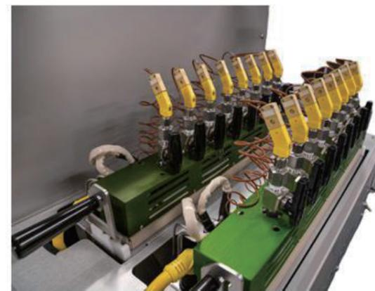
双模 OSR，配备用于监测/控制反应温度的原位热电偶
