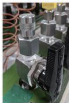
用于原位进样/取样的隔膜端口
