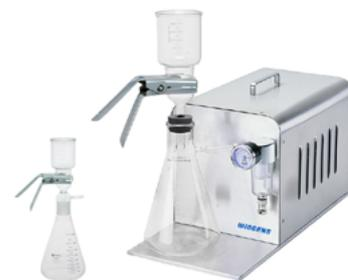
该套装可应用于 HPLC、GC、AA 等微量分析的样品前处理或溶剂 (Mobil phase) 纯化
