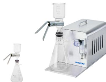
该套装可做为一般的抽滤系统使用，特别为悬浮固形物测定所设计
