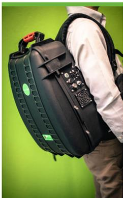
GasScouter 也是极好的土壤通量测量的仪器。采样系统自带一个内置泵，不仅可用于野外连续探索作业，也能做闭路式的土壤气室研究，所以其在野外有广泛的用途。
