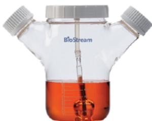
Magna Flex 培养瓶内置了一个 flex 球形玻璃搅拌桨, 该搅拌桨会从一个固定位置沿着瓶底的凹槽在液面以上旋转。专为微载体培养设计, 独特的搅拌系统增强了搅拌效果, 同时轻柔的搅拌方式使培养液充分循环, 确保了载体珠的悬浮。所有该类型的培养瓶都被设计成有 1:1 或更大的顶部空间。
