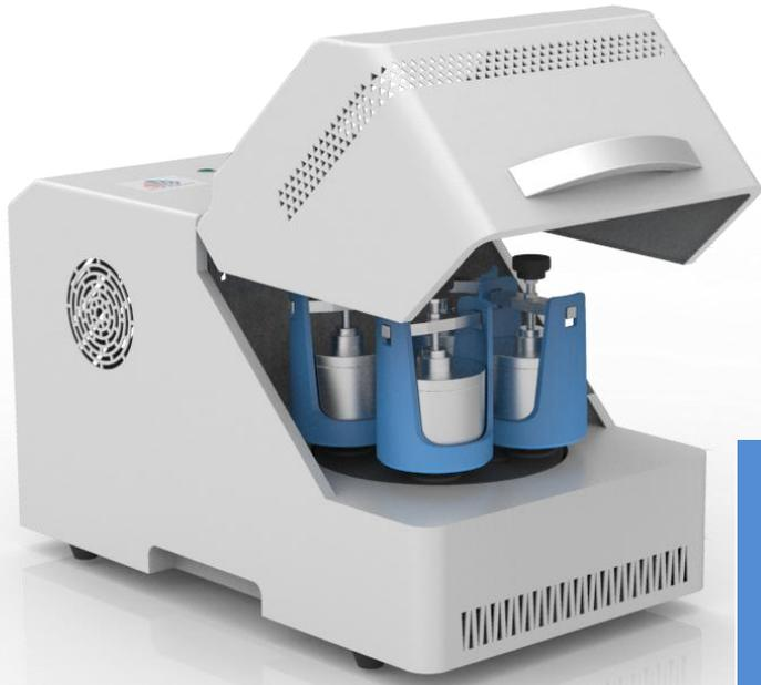
行星式球磨仪的原理是在研磨载体的几何结构和特殊运动方式的作用下，研磨介质与样品之间所产生的高频率、高强度的碰撞、剪切、摩擦，最终使得样品达到极其优秀的研磨效果，具有处理速度快，出样粒度小、均匀、一致等特点。
