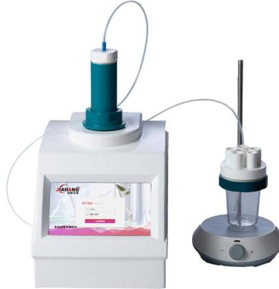
全自动电位滴定仪是应用电位滴定法进行容量分析的高精度电化学分析仪器，采用模块化设计，由容量滴定装置、控制装置、测试装置三部分组成，可进行酸碱滴定、氧化还原、沉淀和络合等多种滴定。仪器有常量滴定、微量滴定、终点设置滴定、体积设置滴定及模式滴定等功能，用户也可根据实际需求自行建专用滴定方法。
