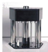
清洗站：比色杯自动清洗，实现无人操作
