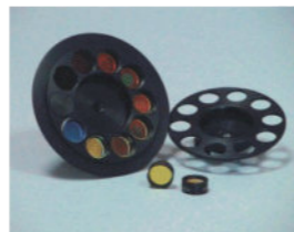
滤光轮：9个光学滤光片和1个黑色滤光片
