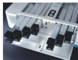
样品架：5个独立样品架，可放置126样品，允许测定过程中连续添加样品
