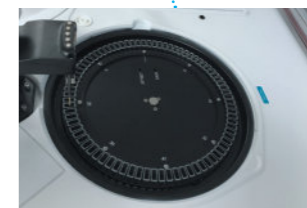
可重复使用比色杯 光学质量自动监测
