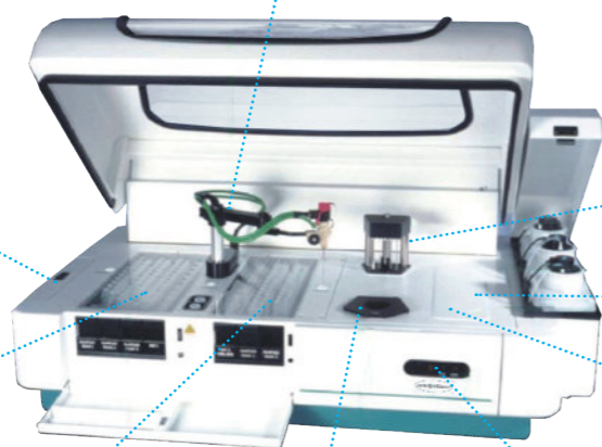
试剂架：2个独立试剂架+2个专用稀释位
