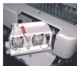
镉柱模块：选配镉柱模块测定硝酸盐（专利技术）
