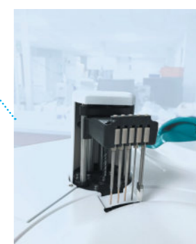
智能清洗工作站 自动清洗比色杯
