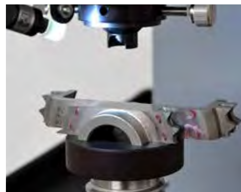
主机附带标配 2.5in [63mm] 平试台 编号: 900001236
