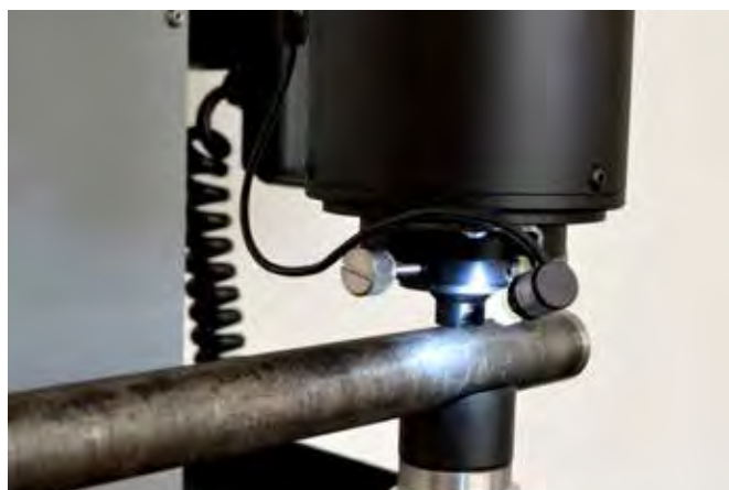
V 型试台和夹紧装置 编号: 900030797 和 W2100CL
