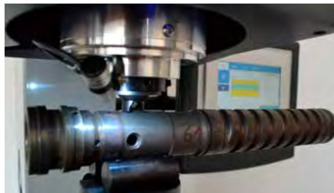
双圆柱试台 适用于直径在 50mm 到 203mm 的圆柱形件 编号: 900007147
