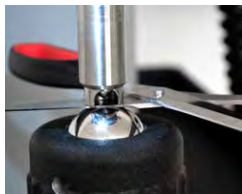
眼球形试台 此试台用于对齐稍带锥度的样品, 如刀片 编号: 900007088
