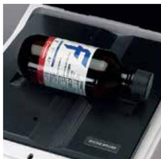
玻璃瓶样品架，检测标准瓶内的样品。
