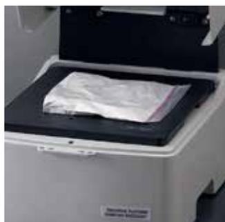
平板式通用样品架，检测塑料袋或玻璃瓶等不同形式的样品。
