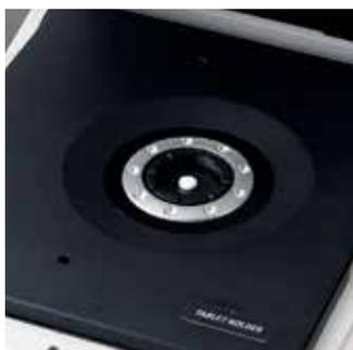
片剂样品架，检测不同大小的颗粒和片状样品。
