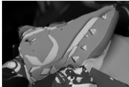
使用低加速电压 BSE 探测器在 5 kV 能量下对 BiCaCo 陶瓷器成像，BSE 提供了出色的材料衬度。
