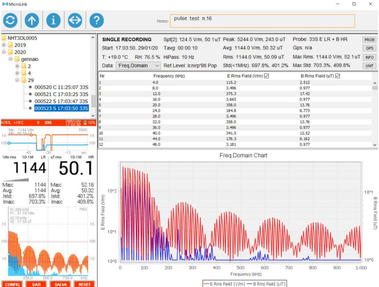
MicroLink 软件是随设备免费提供的一款功能强大的数据管理软件，显示界面简约、直观，通过它，您可以轻松远程控制 NHT-310F 设备，完整的模拟设备显示单元：显示 NHT-310F 的存储状态及将测量数据下载到电脑中或者改变测量的单位，MicroLink 软件甚至直接在远程电脑上显示出虚拟的 NHT-310F 设备及实时振幅、时间图形等信息，这样，远程操作者几乎可以同步对 NHT310F 进行各种控制，这个功能在某些应用下非常实用，比如为检查单个接触面必须让操作者在电磁暗房外进行控制。
