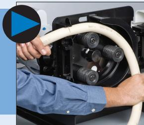
将泵管固定在上方和下方的管夹上。
