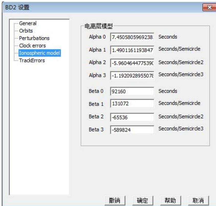
图 2-39 电离层模型参数设置界面
