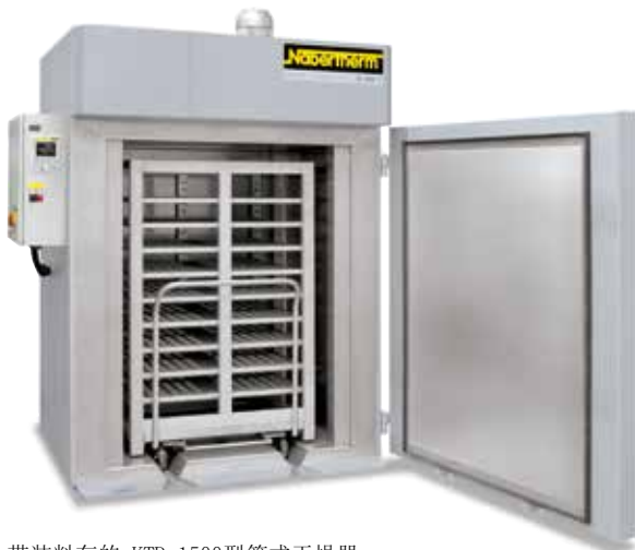
带装料车的 KTR 1500型箱式干燥器
