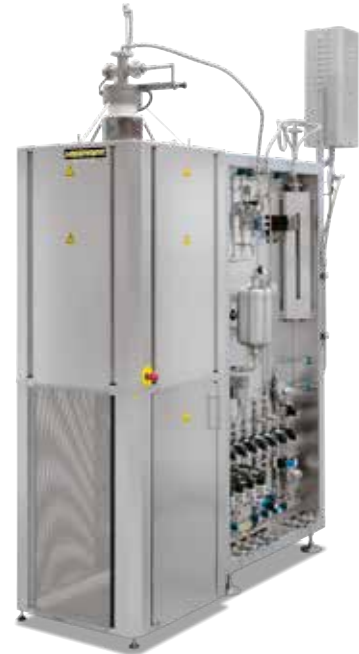
RHTV 120/600/17 H2配备用于可燃气体的供气套件4，回转式吊钩用于装料吊挂，下部法兰前侧装有安全门
