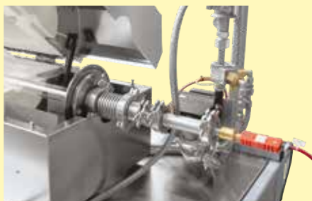
配备气体冷却器和物料热电偶的气密封旋转式接头
