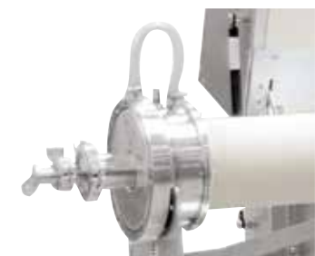
水冷式真空法兰（供气系统2）
