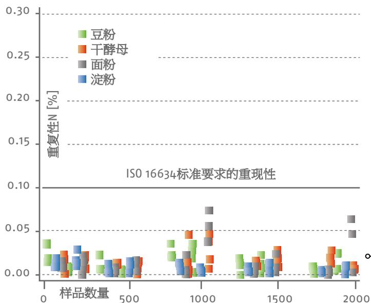
④ 采用rapid N exceed连续分析超过2000次不同基质的样品，仍确保杰出的重复性，且每个数据点都会根据相应的标准去校准。如图：各个样品的分析重复性符合ISO 16634的要求。
