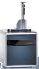
Elementar公司专有的APT技术是非金属元素测定中领先的色谱技术。完全燃烧后生成的气体无需分流和稀释即可通过APT技术分离，甚至可承受高达7000:1的C/N比。卓越的峰分离技术确保绝对可靠，无故障的数据采集。数据分析也因此可以简单的自动处理，最大限度的保证了数据质量。
