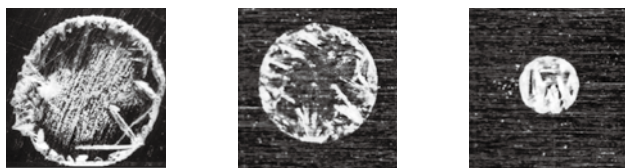
根据不同的样品类型, 可以选择靶点直径不同的AnchorChip靶板。上图分别显示DHB在标准不锈钢靶板、800 mm和400 mm AnchorChip靶板上的结晶(从左到右)。
