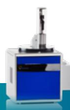
测定固体中的碳含量时，仅区分TIC和TOC往往是不够的。例如：对垃圾进行评估时，还应该单独测定元素碳（ROC），因为这种形式的碳不具有生物可利用性。为此，采用阶梯升温法：在 $400^{\circ}\text{C}$ 条件下测定TOC，在 $400^{\circ}\text{C}$ 至 $600^{\circ}\text{C}$ 之间测定ROC，在 $600^{\circ}\text{C}$ 至 $900^{\circ}\text{C}$ 之间测定TIC。将样品以 $70^{\circ}\text{C}$ 每分钟的速度加热至指定温度，并在设定时间内保持该温度。在不同温度下产生的 $\text{CO}_2$ 代表不同的碳组分。利用soli TOC cube的程序升温功能，按照DIN 19539标准对TOC<sub>400</sub>、 ROC、 和TIC<sub>900</sub>进行测定，简便又可靠。
