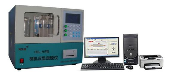
HDL-9W 微机定硫仪是依据国家标准 GB/T214 库仑滴定法的原理,由单片机系统发送控制命令,自动完成实验。也就是说,化验员只需输入样重,其他工作由仪器自动完成。仪器既可以微机工作又可以改为液晶面板操作,两用型,开机的同时按仪器面板上的白色"数字键"改为汉显液晶模式,按蓝色"方向键"改为微机电脑模式。关机后自动保存,下次开机不做修改,自动默认上次操作模式。适用于电力、煤炭、冶金、石化、环保、水泥、造纸、地堪、科研院校等行业部门测量煤炭、焦炭、石油、矿石,石墨等其他可燃物质的硫含量。
