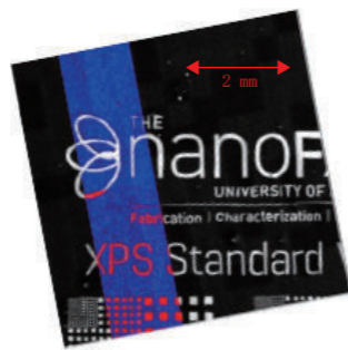
SXI影像：5.5 mm x 5.5 mm 化学组分成像 Ti 2p (红色)：2.7 mm x 1.4 mm Si 2p (蓝色)：5.5 mm x 1.4 mm
