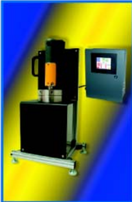
◀ 配有 300ml 釜体的 HPR 高压反应系统
