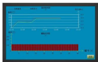
柱形图显示温度和运行曲线
