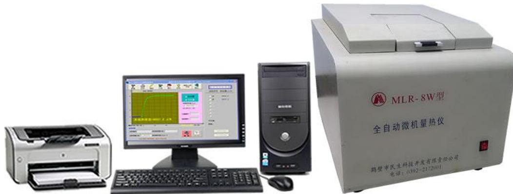
由微机控制的恒温氧弹式量热仪，适用于测量固体和液体如煤炭、电力、石油、化工、粮食、地质、科研及技术监督等部门的化验室。微机量热仪的采温、搅拌、点火、调温、定量水等操作均由计算机自动控制完成。微机量热仪热容量的标定、弹筒发热量的计算及对于煤的各基发热量的换算亦由计算机根据操作人员输入的各种已知含硫量或含氢量以及水分含量自动完成。由打印机将测量数据和结果打印输出或以文件形式存盘。
