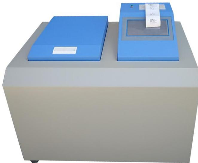
采用彩色触摸显示器，中文显示。测量过程自动控制，操作简便，用户只需装好氧弹并输入相关数据即可自动完成测量全过程，降低人为误差。实验结束自动打印弹筒、干基高位、分析基高位、分析基低位、收到基发热量，结果清晰明了。实验结果符合国标 GB/T213-2008《煤的发热量测定方法》的要求。适用于固态、液态以及生物质燃料可燃物质的发热量测定。
