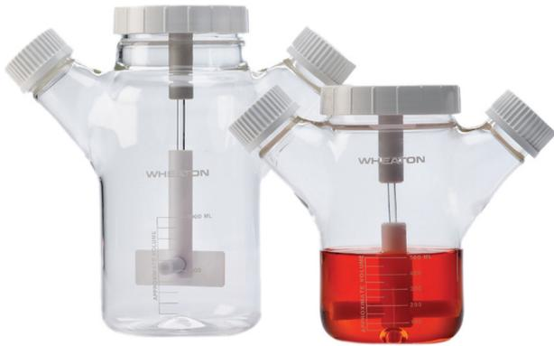
Celstir 细胞培养瓶含有一个高度可调的叶片状短桨，搅拌更充分。培养瓶底部附加了凸起，增强了搅拌的效果并避免了细胞在瓶底的沉积。
