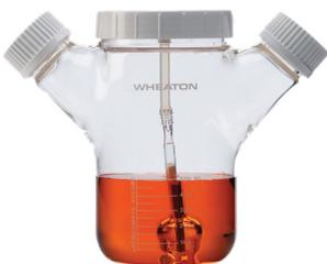
Wheaton Magna Flex 培养瓶内置了一个 flex 型球形玻璃搅拌桨, 该搅拌桨会从一个固定位置沿着瓶底的凹槽在液面以上旋转。专为微载体培养设计, 独特的搅拌系统增强了搅拌效果, 同时轻柔的搅拌方式使培养液充分循环, 确保了载体珠的悬浮。
