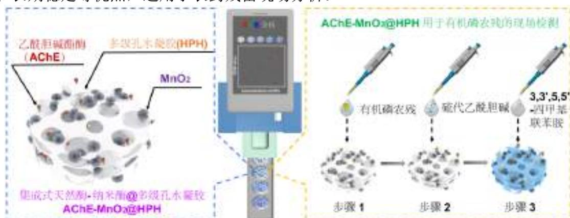
图 1. 基于集成式 AChE-MnO<sub>2</sub>@HPH 的智能手机辅助农残检测示意图
