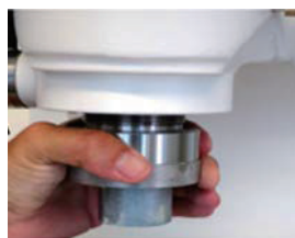
轴套保护，有效防止运行过程中误打开转鼓
