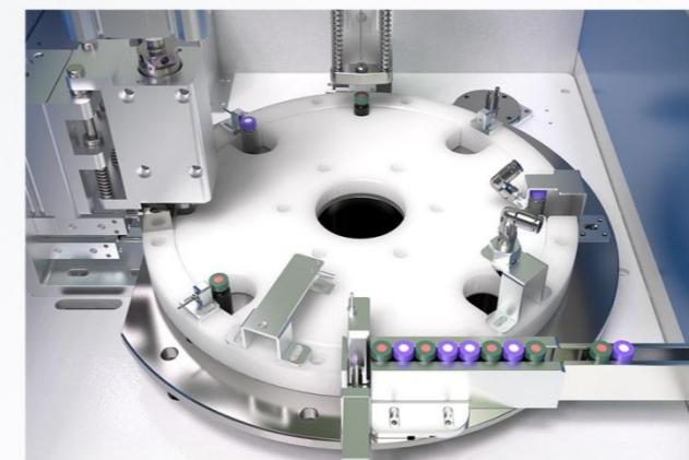
该模块实现对样品瓶的有序进料，向下一模块--拔盖单元送入姿态正确的样品瓶。样品瓶在此模块中，可逐一进入设计好的固定拔盖工作位，便于拔盖单元的机构完成拔盖动作。
