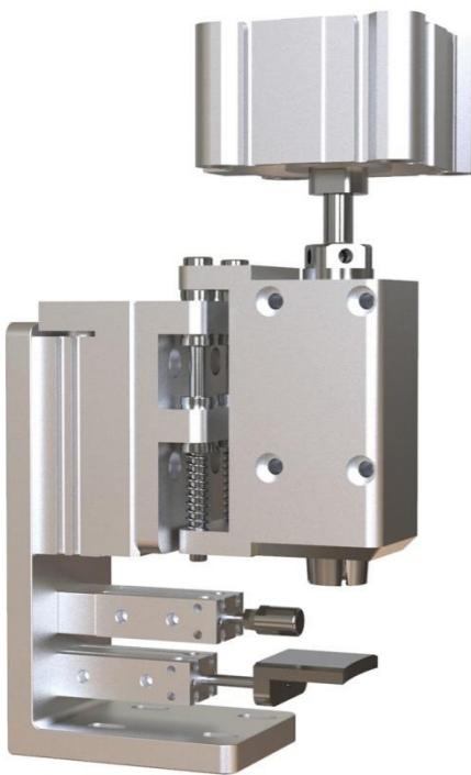
该单元实现对样品瓶盖子的开启。拔盖单元的瓶盖夹具在气动推头的驱动下，向上一模块输送到固定位的样品瓶盖运动，到达瓶盖位置后夹具在气缸动作下完成夹盖和拔盖动作，动作扭力通过调试，可顺畅完成样品瓶和瓶盖的分离而不破坏瓶身。
