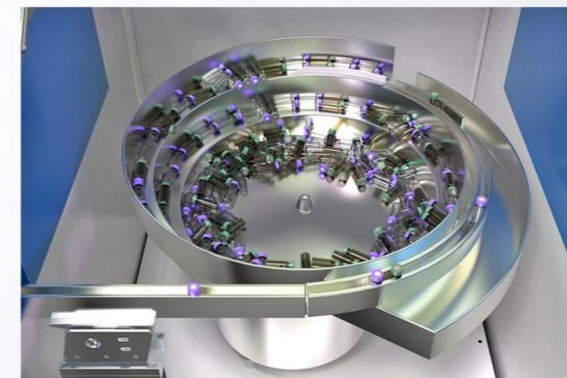
该模块实现对样品的盛装和自动进料，可一次盛装2400个小样品瓶。样品瓶的进料无需刻意摆放，模块通过震动方式向下一个单元--转盘排瓶模块送料，完成小样瓶姿态矫正，保证每个瓶子的瓶口向上。
