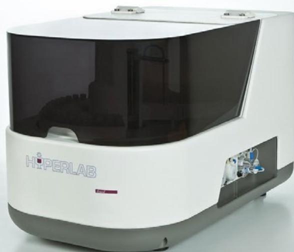
Hyperlab SMART 是 Biostream 新上市的多参数分析仪，是一款多参数自动分析系统，针对生物、食品及饮料中一些常规物质含量进行快速检测，其中包括：乙酸、柠檬酸、葡萄糖酸、乳酸、苹果酸、丙酮酸、酒石酸、二氧化硫、总多酚，以及钙、镁、铁、铜、钾等进行自动分析。分析仪内置各种托盘，用于盛放样品、试剂，以及反应池等，取样机械臂由微处理器控制，根据程序可自动取样、稀释（如果方法需要）和相关试剂的抽取。样品和试剂自动加入反应池后，在某个恒定温度下反应足够长的时间，以保证反应能进行完全，然后进行自动检测。在每次抽取样品后，取样针都会被自动清洗干净，以防止试剂和样品之间的交叉污染。反应池干燥后，在下次分析之前，会进行准确地光路校准。每小时可分析 150 次。
