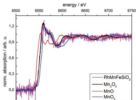
用于合成气转化的纳米颗粒催化剂的氧化态分析。加入Mn和Fe作为促进剂调节反应的选择性。
