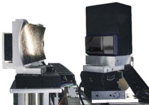
hiXAS内部的晶体和探测器示意图。HAPG晶体是专门针对目标应用进行优化的。可同时获得极高的分辨率和效率。配置大面阵混合像素光子计数型探测器，使系统能够进行原位测量。
