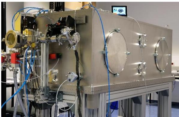
在实验室中使用hiXAS。模块化设计支持系统定制，可提供非常紧凑的版本。不同的样品类型之间可灵活切换，例如粉末，箔，液体样品仓。
