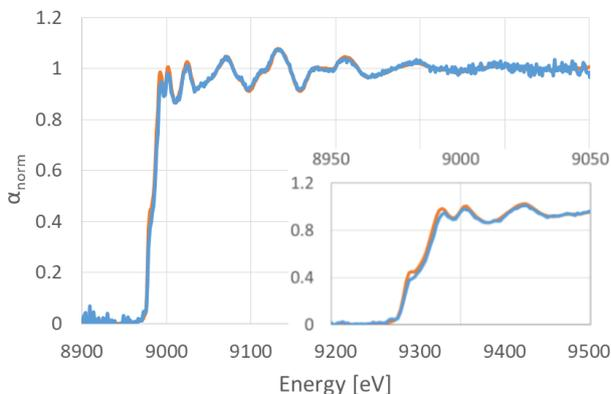
厚度为10 $\mu\text{m}$ 的Cu箔的XANES光谱图，比较了hiXAS (分辨率  $E/\Delta E = 4000$ , 蓝色) 和同步辐射(APS 光束线13-ID-E, 分辨率  $E/\Delta E = 8000$ , 橙色) 。
