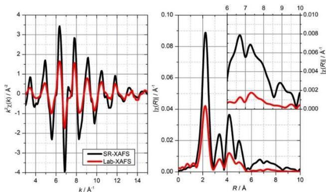
10 $\mu$ m铜箔的XAFS测试, 比较了hiXAS (红色) 和同步辐射 (黑色) 的测试结果。左图为EXAFS的振荡图, 右图为相应的傅里叶变换曲线。所有峰值精确重现。测量时间3分钟。
