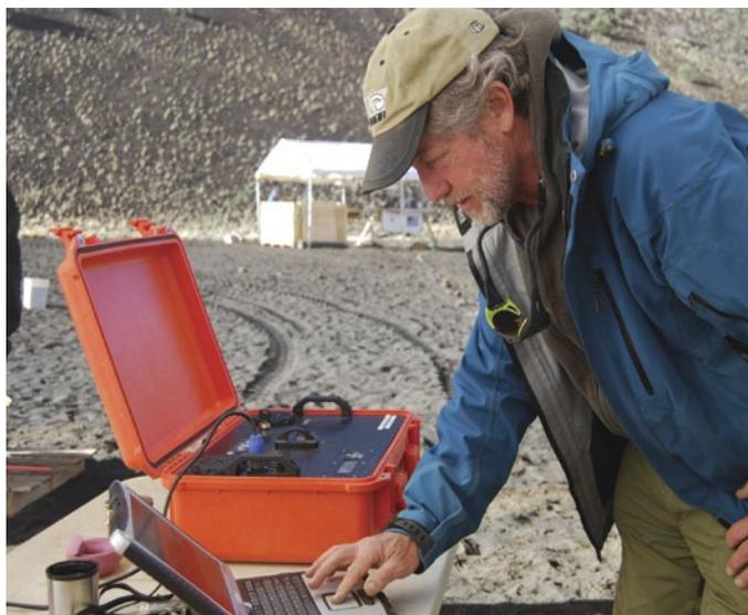
Olympus的Terra分析仪最初的研发目的是为NASA的火星科学实验室（MSL）项目进行化学和矿物学检测，如今已经发展成一款利用XRD/XRF两种高级技术、进行日常实际应用、坚固耐用、便携性能极强的野外作业仪器。Terra将Olympus和NASA的创新成果结合在一起使用，开创了同时使用X射线衍射和X射线荧光技术进行测量的新方式。
