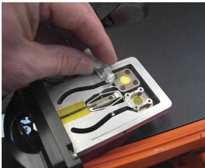
Terra极大地简化了X射线衍射实验中的样本采集工作。一般来说，为了确保晶粒可以在大量足够的方向上无序衍射，应该将样本研磨成粉末并碾压成小球状。
