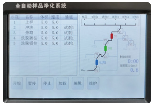
软件实时显示压力检测和方法倒计时,直观的显示仪器运行状态
