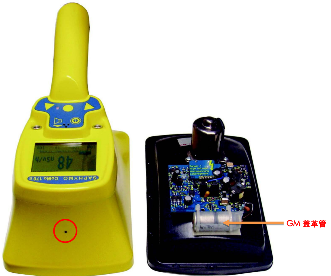
图片中红圈处, CoMo170 内部集成了一个小型 GM 管 (用于 \gamma 、x 射线的辐射剂量测量)
