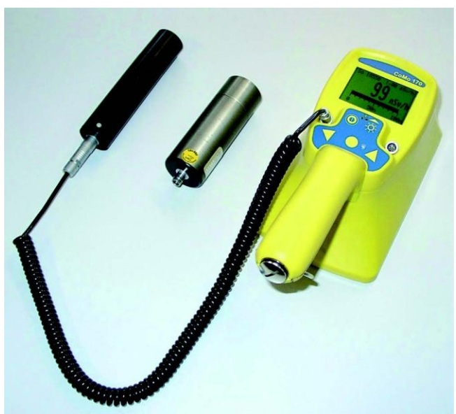
连接外接式额外 \alpha 、 \beta 探测器工作的 CoMo 170
