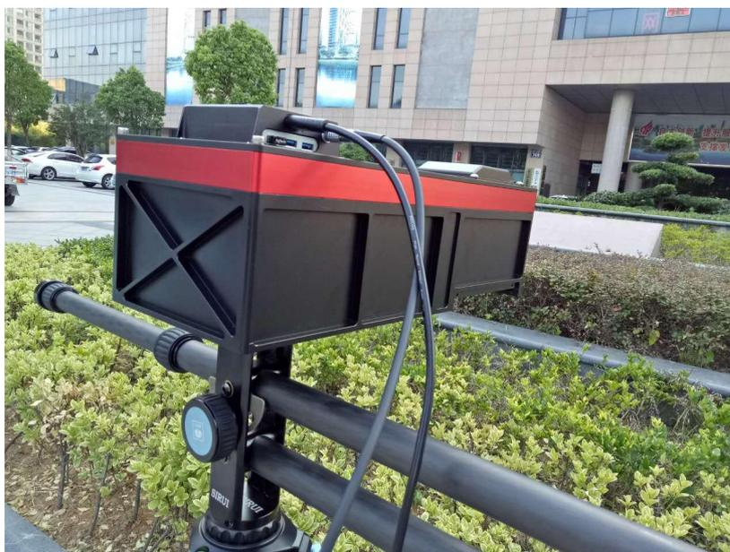
图 11 奥谱天成高光谱成像仪外场实验场景 5
