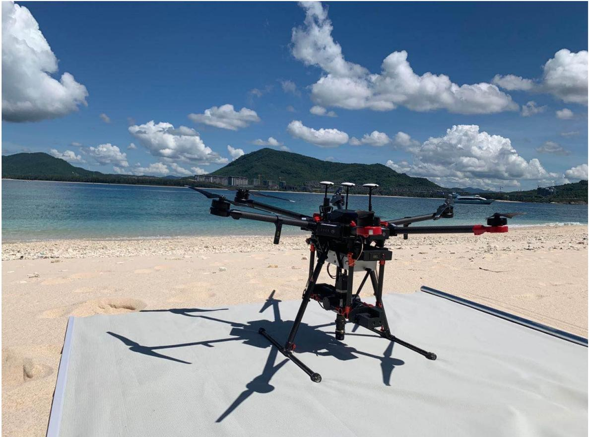
图 33 奥谱天成的无人机高光谱成像系统
