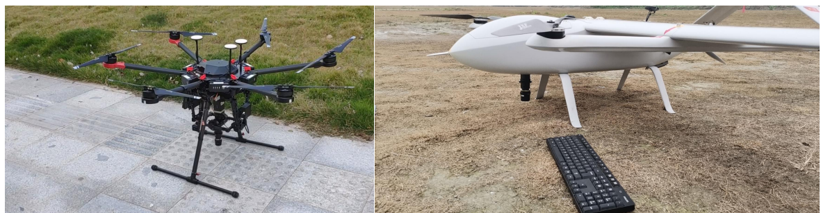
图 1 左边为 ATH9500 (多旋翼), 右边为 ATH9500FW (垂直起降固定翼)
